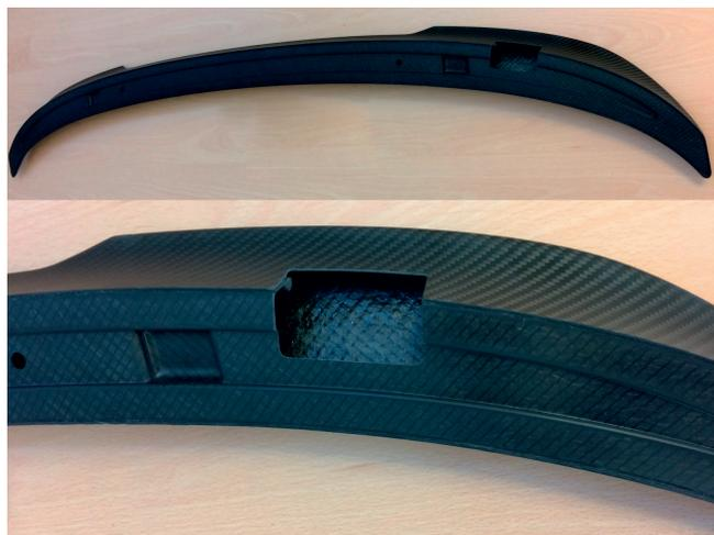
**Bild 4.** Bei dem Heckspoiler kommt im Inneren ein CF-Prepreg zum Einsatz. Er besteht zu ca. 65 % aus rezyklierten Carbonfasern (© Cotesa)
