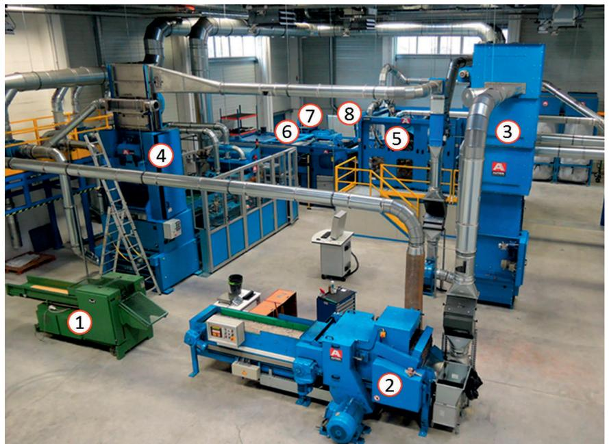
Carbonvliesstoffanlage des STFI mit Fallschneidemaschine (1), Reißmaschine (2), Füllschacht (3), Airlay (4), Krepmpel (5), Kreuzleger (6), Nadelmaschine (7) und Nähwirkmaschine des Typs Maliwatt (8) (© STFI)
